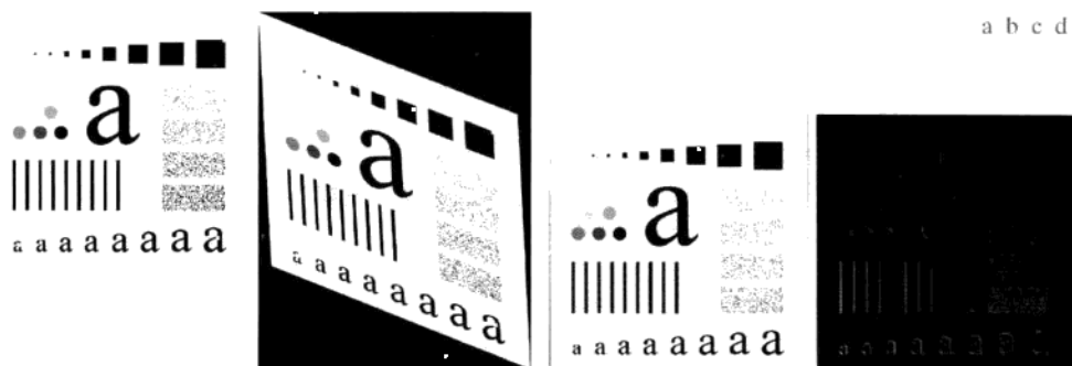
图 2.37 图像配准: (a) 参考图像; (b) 输入图像(几何畸变图像), 相应的约束点以靠近角点的白色小方块显示; (c) 配准后的图像(注意边界上的误差); (d) 图(a)和图(c)的差, 显示了更多的配准误差
