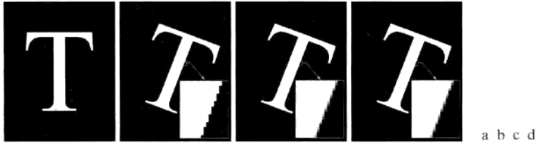
图 2.36 (a) 字母 T 的 300 dpi 图像; (b) 旋转 21° 并用最近邻内插给经空间变换后的像素赋灰度值后的图像; (c) 旋转 21° 并用双线性内插赋灰度值后的图像; (d) 旋转 21° 并用双三次内插赋灰度值后的图像。放大部分显示了三种内插方法的边缘细节
