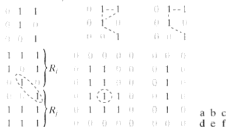
图 2.25 (a) 像素的排列; (b) 8 邻接像素(邻接性由虚线所示, 注意二义性); (c) m 邻接; (d) 采用 8 邻接时, 两个值为 1 的区域是邻接的; (e) 如果在区域和背景间采用 8 邻接, 则加圆圈的点是仅赋 1 值的像素的边界点的一部分; (f) 1 值区域的内部边界不形成闭合通路, 但其外部边界可以形成闭合通路
