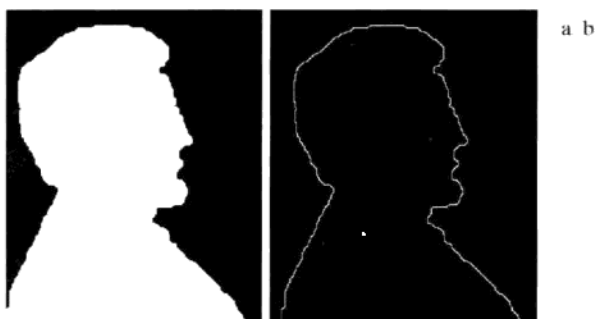
图 9.14 (a)一幅简单的二值图像，其中 1 表示白色；(b)使用式 (9.5-1) 和图 9.13(b) 中的结构元得到的结果
