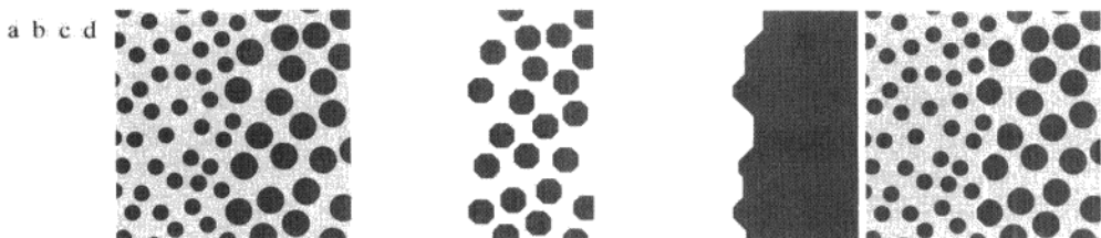
图 9.43 纹理分割：(a)由两种斑点组成的大小为 600×600 的图像；(b)对图(a)执行闭操作后删除了小斑点的图像；(c)对图(b)执行开操作后删除了大斑点间的亮间隔的图像；(d)将图(c)中两个区域间的边界叠加到原图像上后的结果。边界是使用形态学梯度操作得到的
