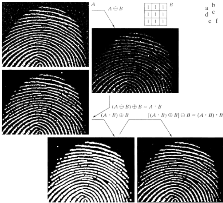
图 9.11 (a) 噪声图像; (b) 结构元; (c) 腐蚀后的图像; (d) A 的开操作; (e) 开操作的膨胀; (f) 开操作的闭操作(原图由美国国家标准和技术研究所提供)
